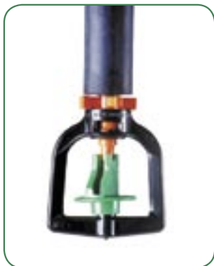
Bailarina Cinza – vazão: 31lpb Pressão de serviço: 1,5 kgf/cm 2
